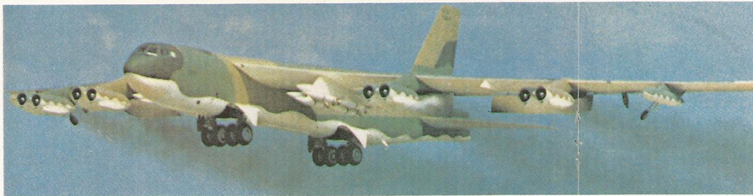
СТРАТЕГИЧЕСКИЙ БОМБАРДИРОВЩИК В-52G «СТРАТОФОРТРЕСС». Дальность полета с максимальной боевой нагрузкой 13 700 км. Вооруженные ударными ракетами СРЭМ и ядерными авиабомбами бомбардировщики В-52G и В-52Н составляют основу ударной мощи стратегической авиации США.
